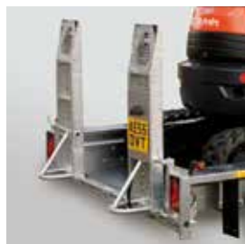
Rampes réglables de chargement, béquilles intégrées
