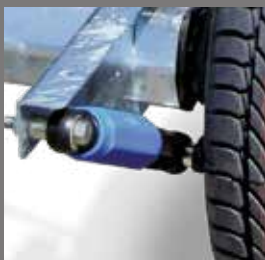
Wheel shock absorbers (standard on some models) Amortisseur de roues (en partie de série) Wielschokdempers (deels standaard)
