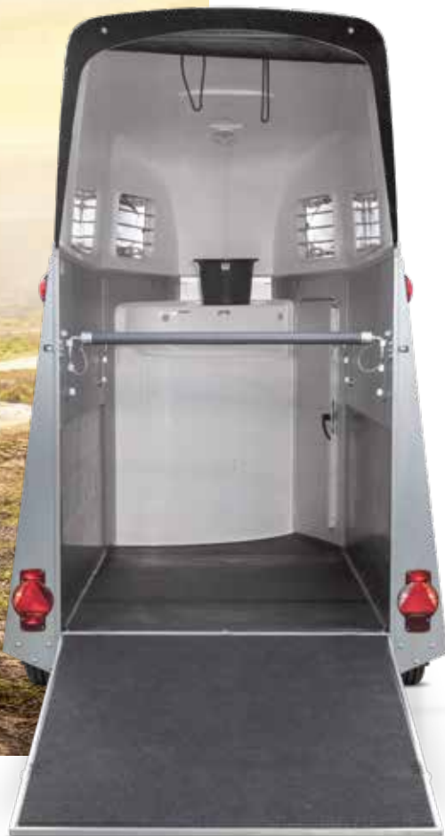
Three-way adjustable breast and breech bars Barres de poitrail et de recul réglables dans trois positions Drievoudig verstelbare borst- en achterstangen
